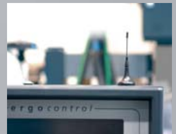
GSM antenna for ErgoSMS on a Demag IM machine
